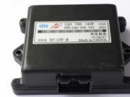
Car Gateway 汽車網關控制板
