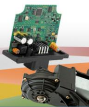
Steering Wheel Angle Sensor 方向盤傳感器控制板
