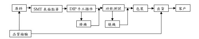
備註:本公司所製造生產之電腦、通訊及消費性電子等 3C 電子產品之主板及週邊卡,除 TFT-LCD 驅動控制板外,一般而言其主要產製過程如上所示。
