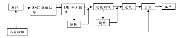
備註:本公司所製造生產之電腦、通訊及消費性電子等 3C 電子產品之主板及週邊卡,除 TFT-LCD 驅動控制板外,一般而言其主要產製過程如上所示。
